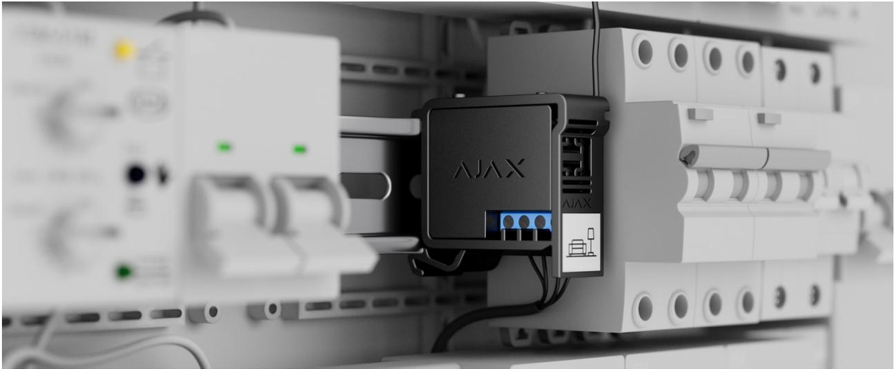
El dispositivo se conecta a la red de 110/230 V~. Las dimensiones del WallSwitch (39 × 33 × 18 mm) permiten instalarlo en una caja de conexiones profunda, dentro de la carcasa de un aparato eléctrico o en un tablero eléctrico. La antena externa flexible garantizará la estabilidad de la comunicación. Para instalar el WallSwitch en un carril DIN, recomendamos utilizar el [DIN Holder](#).
