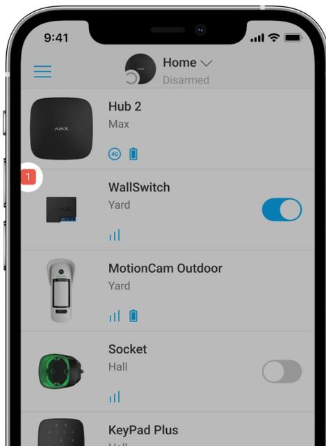
En caso de un fallo de funcionamiento del WallSwitch (por ejemplo, se perdió la conexión Jeweller entre el hub y el relé), la app Ajax muestra un contador de fallos de funcionamiento en la esquina superior izquierda del icono del dispositivo.
